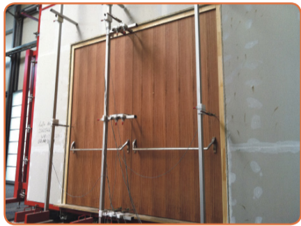
Rooktest. Foto: Reinaerdt Deuren.
